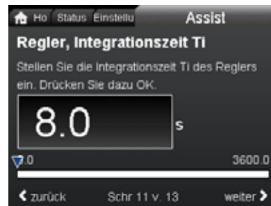
Abb. 56 "Regler, Integrationszeit Ti"
