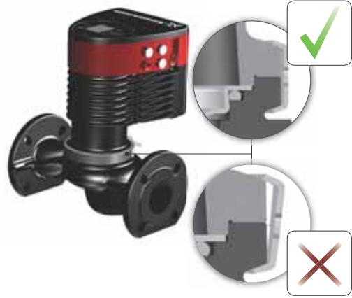
Abb. 9 Montieren des Pumpenkopfs auf dem Pumpengehäuse
