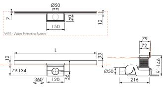
Fliese, Sperrwasserhöhe 50 mm, Bauhöhe 91 mm
