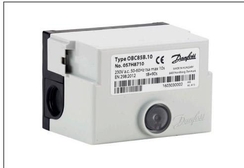
Der mikroprozessorgesteuerte Ölfuerungsautomat OBC 85B.10 hat, unabhängig von der Versorgungsspannung und der Umgebungstemperatur, präzise und stabile Programmzeiten. Der Automat ist unterspannungssicher gemäß EN 298:2012. Im Falle von Unterspannung wird der Automat
