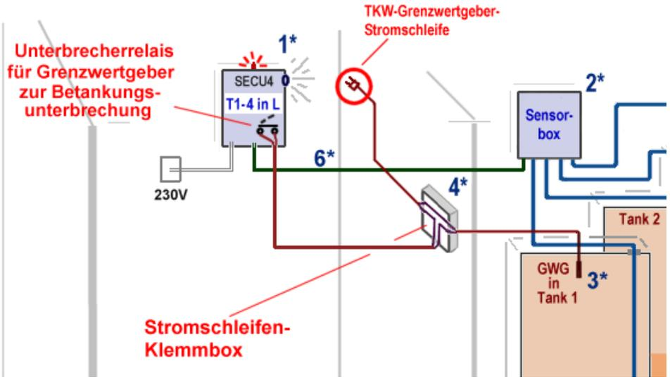
4\* = Anschlussbox für den Grenzwertgeber-Stromkreis zum TKW
