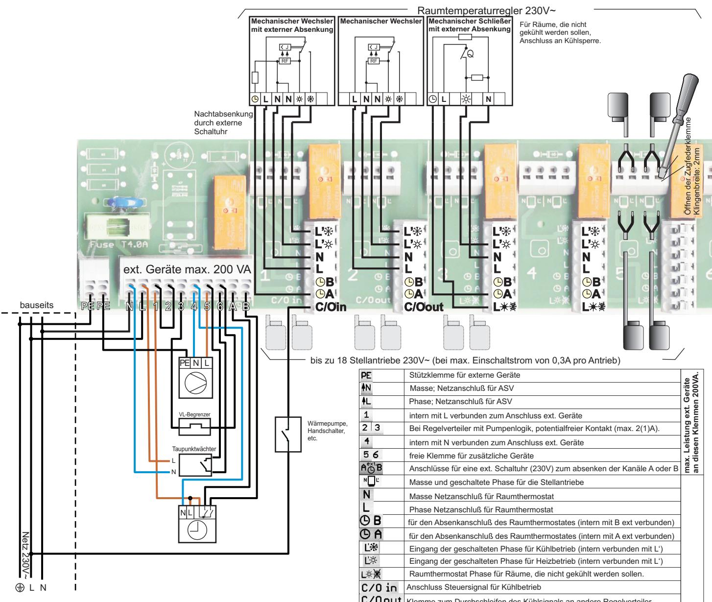
Bei Störung zuerst korrekten Anschluss, die Sicherung und Spannung überprüfen.
