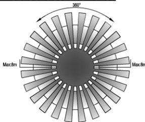
Die maximale Reichweite beträgt in etwa 8Meter. Die Reichweite kann je nach Umgebung variieren.
