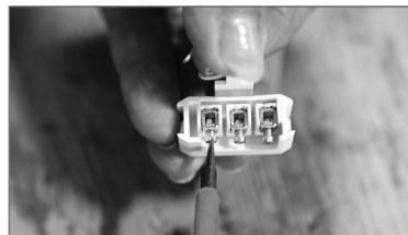
Für die Installation des Systemsteckers (1) schließen Sie die Leitungen an dem Systemstecker (1) an und sichern die Anschlüsse durch die Verschlussklappe.
