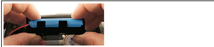
6. Neuen Akku in die Halterung einlegen. Darauf achten, dass die Leitung der Steckverbindung seitlich aus der Halterung herausgeführt wird. Akku bis zum Einrasten der Halteclips in die Halterung drücken.
