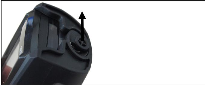
1. Kondensatauslass an der Kondensatfalle öffnen: Stopfen max. bis zum Anschlag herausziehen.
