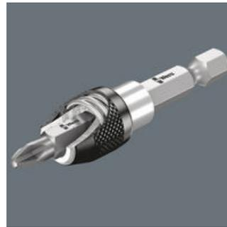
Wera Schnellwechselhalter stellen eine feste, wackelfreie Verbindung zwischen Halter und Bit her. Die Halter sind so konstruiert, dass beim Bitwechsel die äußere Hülse nach vorn geschoben wird und der Bit leicht eingesetzt und entnommen werden kann. In magnetischer Ausführung zum leichteren Ansetzen der Schrauben.
