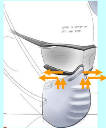
Beim Tragen einer Atemschutzmaske, auch mit einer guten Dichtung, wandert warme Luft nach oben und entweicht im Bereich der Nasendichtung, was zum Beschlagen der Sichtscheiben führt.
