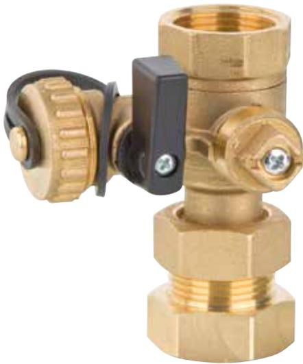
Ausdehnungsgefäße sind Sicherheitseinrichtungen für geschlossene Heizungsanlagen und dürfen gegen den Wärmeerzeuger nicht absperribar sein. Absperrrichtungen müssen gegen unbeabsichtigtes Schließen gesichert werden. (DIN 4751 Teil 2)
