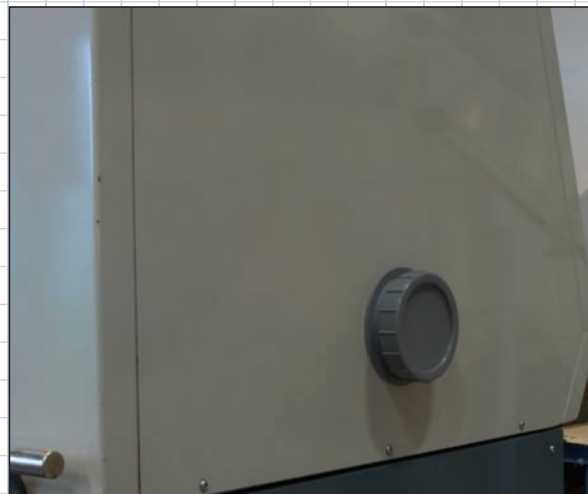
Reinigungs-Verschraubung - Kreisschneider Ø 121 mm erforderlich.
