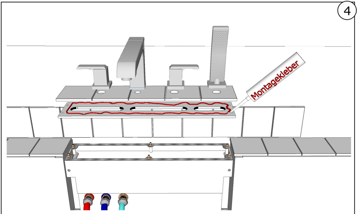
Fliesen bohren, ggf. zuschneiden und auf der Armatureträgerplatte mit einem aushärtenden Kleber anbringen. Wir empfehlen Racofix Montagekleber von Sopro. Die Armatur anschließen und auf die geflieste Armatureträgerplatte montieren. Montageanleitung der jeweiligen Armatur beachten.
